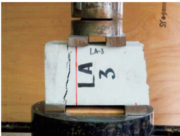
写真1 せん断破壊状況（左せん断面）
